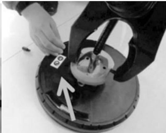
Haga pasar el tornillo negro a través del brazo de soporte y el conjunto de aluminio, y apriételo firmemente con un destornillador plano.
