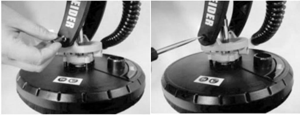
Coloque la abrazadera de la manguera de aspiración de polvo en la abertura de la cubierta de plástico y apriete el tornillo de la abrazadera firmemente con un destornillador plano.
